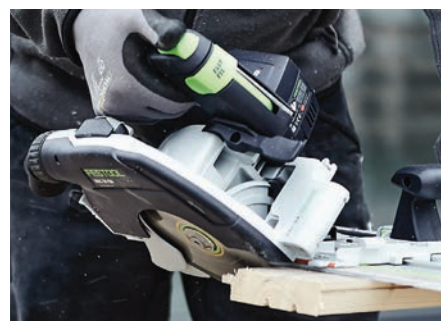
Afkortrail met aanslagsysteem voor herhalingsnauwkeurige hoekzaagsneden.
