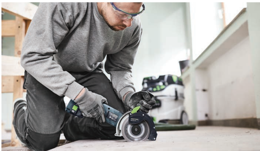
De stofzuigkap transporteert > 95 % van het stof rechtstreeks naar de aangesloten stofzuiger.
