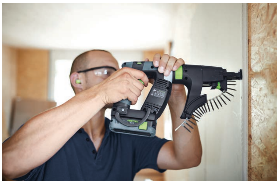
Snel werken met magazijnadapter.
